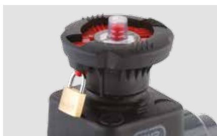
Для повышения защиты установки от несанкционированного доступа можно также установить висячий замок, предварительно поднимая маховик в положение блокировки
