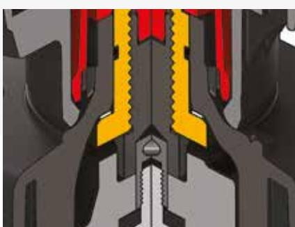
**Соединение плавающим пальцем** между винтом управления и мембраной позволяет избежать концентрации нагрузок, что **повышает степень уплотнения** и срок службы клапана.
