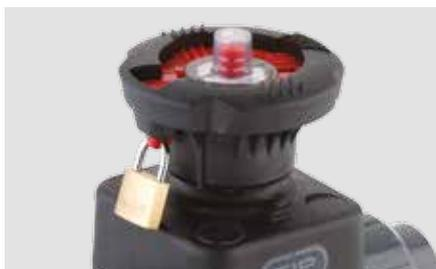
Для повышения защиты установки от несанкционированного доступа можно установить навесной замок, предварительно подняв маховик в положение блокировки
