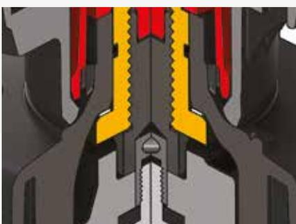
**Соединение плавающим пальцем** между винтом управления и мембраной позволяет избежать концентрации нагрузок, что **повышает степень уплотнения и срок службы** клапана.
