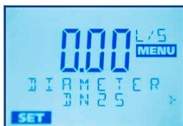
Выбор **размера трубы** позволит **ASEC улучшить рабочие характеристики прибора**.
