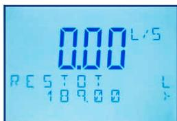
Значения расхода и обнуляемого счетчика-сумматора.
