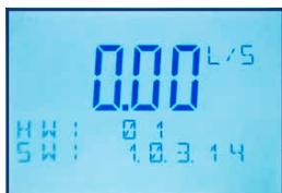
Расход и версия аппаратного оборудования и версия программного обеспечения.
