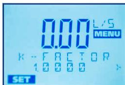
Задайте **коэффициент «К»** для правильного преобразования частоты датчика расхода в **расход**. Коэффициент «К» коррелируется с: **моделью датчика и фактическим внутренним диаметром** (размером трубы, материалом трубы, стандартом трубы). Для получения правильного значения см.
