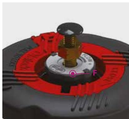
Мембранный клапан исполнения DKL оснащен системой регулирования хода маховика, позволяющей установить максимальную и минимальную пропускную способность клапана и предупреждать слишком сильное сжатие мембраны при закрытии.
